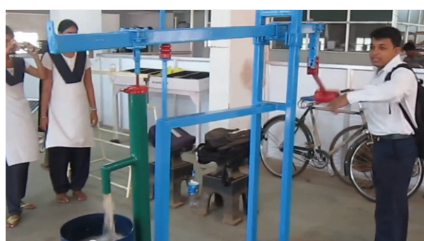
Slika 4. Replika ručne pumpe za vodu sa klatnom iz Indije, Arun Sahoo, 2013. http://youtu.be/8n7mvpLpP5A
