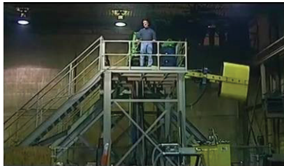
Slika 8. Postrojenje sa klatnom od 9 tona
