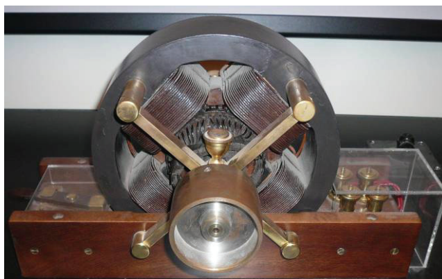
Slika 9. Kopija Teslinog indukcionog motora iz 1887. Muzej Nikole Tesle, Beograd
