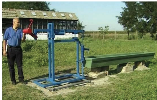
Ručna pumpa za vodu sa klatnom na terenu (okolina Novog Sada, avgust 2004.) http://youtu.be/hNpql7o_1QI
