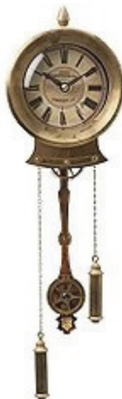
Slika 2. Zidni časovnik sa regulacionim klatnom i dva pogonska teža, od kojih jedan pogoni sat, a drugi otkucava sate.
