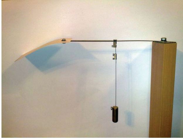
Slika 8. Jedan od brojnih modela sa elastičnim klatnom, čime se ostvaruje duže trajanje oscilacija i veća frekvencija.
