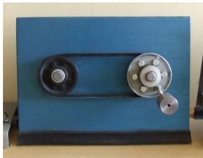
Slika 9. Prenosnici reduktori - rotacija traje od 1 - 2,5 sek.
