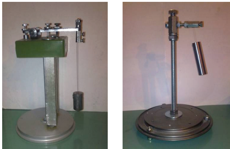
Slika 5. Elastična klatna koja su korišćena pri merenju i dokazivanju superiornosti oscilacija, a slični modeli mogu biti i edukativne igračke.
